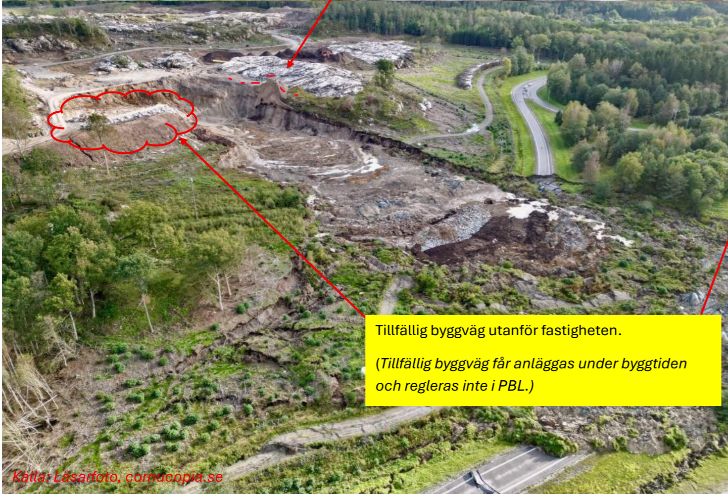
Figur 40. Uppfyllnad utförd som vall med genomförd avsläntning tre dygn före skredet. Uppfyllnaden med arbetsväg och sprängsten markerat med ett rött streck. Arbetsvägen knöt samman berg markerat med röd ring på ömse sidor av uppfyllnaden. Bilden är beskuren av SHK. Foto: Mikael Berglund.
