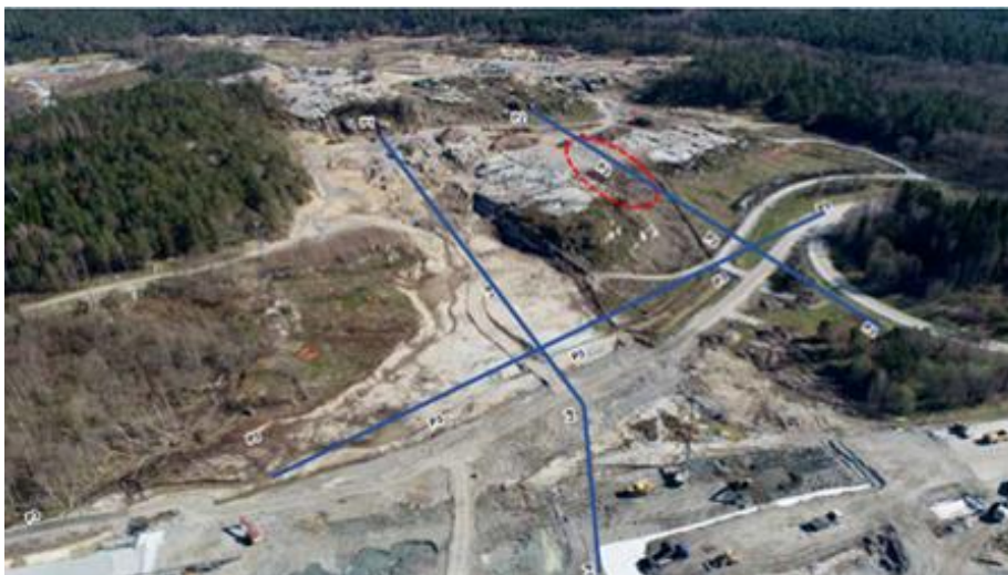
Figur 64. Översiktbild över skredområdet med fastigheten Hammar 1:16 inringad av SHK i rött. De tre sektioner (P1, P2 och P3) som studerades har märkts ut i fotografiet av SHK med blå streck. Källa: Uppsala universitet.
