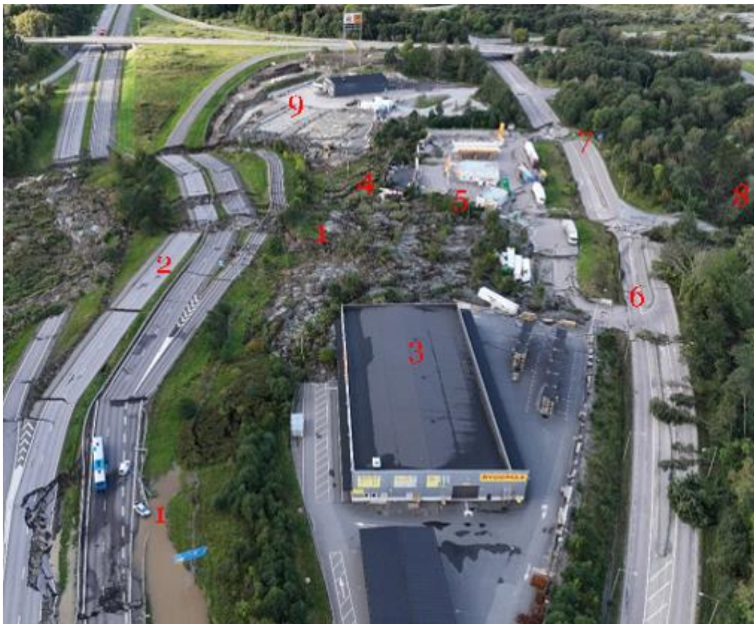
Figur 5. Skadad infrastruktural, skadade byggnader och uppdämda vattendrag på eller vid fastigheten Munkeröd 1:98. 1. Kärrbäcken. 2. E6. 3 Byggmax. 4. Burger King. 5. Preem, inklusive drivmedelstankar. 6. Ucklumsvägen. 7. Fjärrvärmeledning. 8. Norumsån. 9. Rusta och jem & fix. Foto: PEAB.
