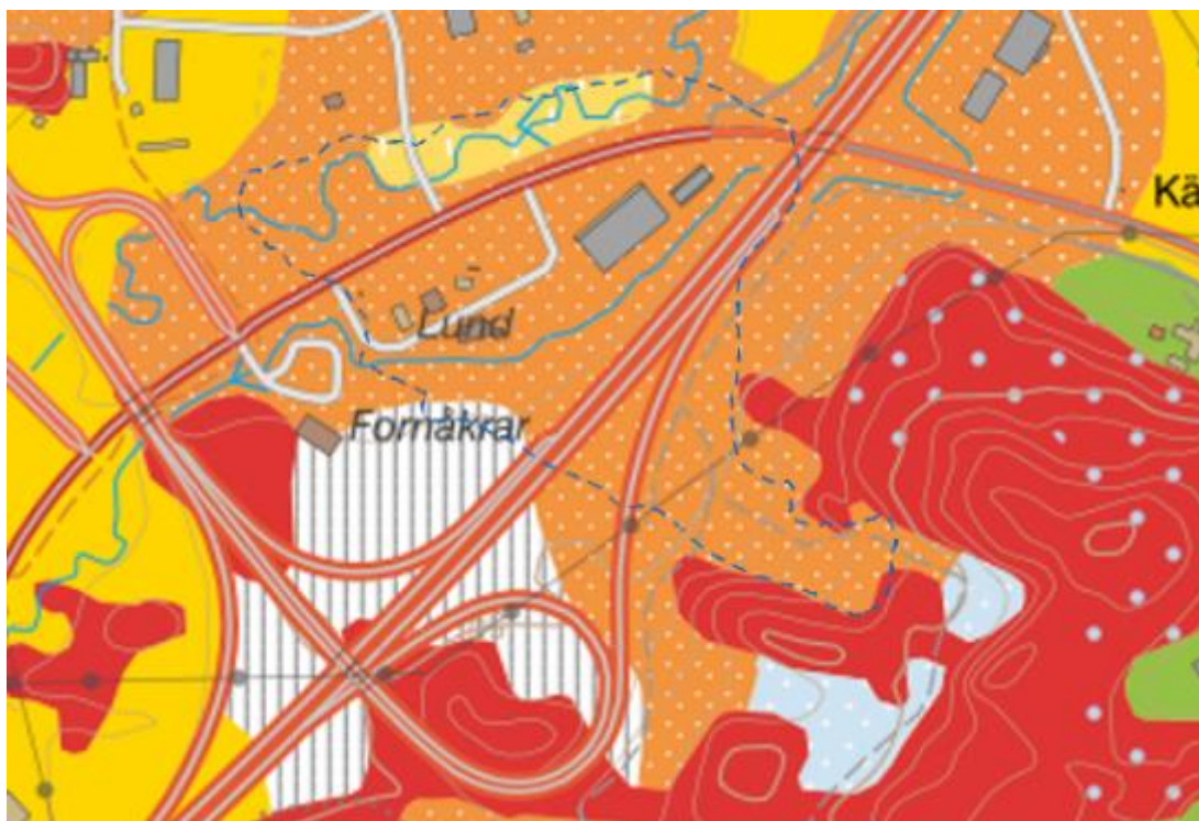
Figur 21. Bild från SGU:s karta "Jordarter" efter uppdateringen 2015. Postglacial sand är markerad med orange prickad mark och urberg med röd färg. SHK har lagt in en streckad blå linje som markerar skredets utbredning. Källa: SGU:s karta "Jordarter".
