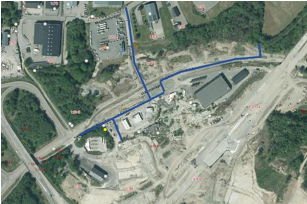
Figur 3. Ledningskarta för Vattenfall Eldistribution AB:s högspänningsnät på fastigheten Stenungsund Munkeröd 1:98. Ledningarna är markerade med blå linjer av SHK. Kartbilden är från efter skredet när återställningsarbetet var långt framskridet. Källa: Vattenfall Eldistribution AB.
