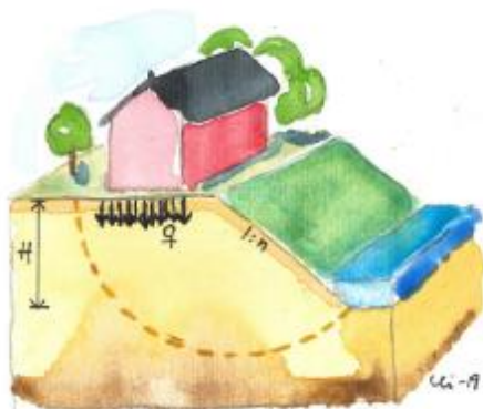
Figur 13. Schematisk figur som visar en cirkulär cylindrisk brottyta (glidyta) i jord. Källa: Skred vid Stenungsundsmotet i Stenungsunds kommun – Geoteknisk utredning av släntstabilitet.
